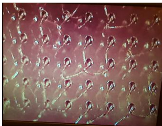
شکل ۶: نمونه‌ای از میکروسوزن‌ها با نوک خمیده در اثر نیروی برشی محلول دولوپر طی فرآیند ساخت.
