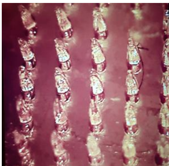
شکل ۷: میکروسوزن‌های مخروطی ساخته شده مشابه با هندسه طراحی شده با تنظیم پارامترهای مؤثر در روش فتولیتوگرافی
